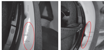
FIG. 5, FIG. 6 Superficial Crack
